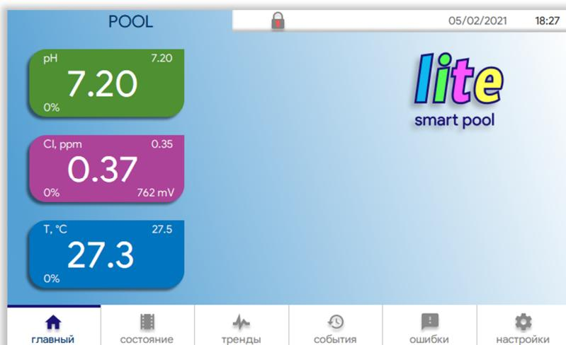
На экране в виде "плиток" отображается информация о работе трёх контуров контроля параметров воды: водородного показателя (pH), дезинфектора (Rx/Cl free\*) и температуры (T). Переход на экран управления контуром осуществляется при нажатии на "плитку" с его названием.
